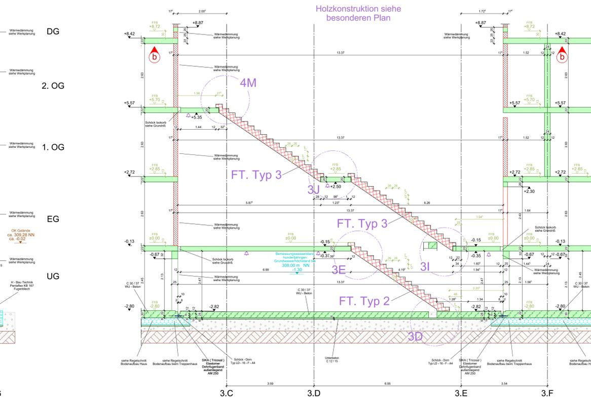
Abstufungen von Fundamenten, die nicht angegeben sind (Höhen-differenz zwischen den verbundenen Fundamenten) werden in Mager-Beton C 12 / 15 ausgeführt.
